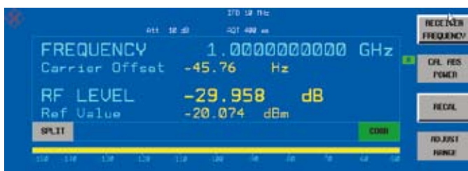
Leistungsmessung mit dem R&S®FSMR.
